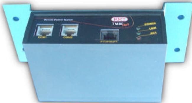
El TM80net es un dispositivo diseñado para integrar dispositivos eléctricos y electrónicos a una red IP con el objetivo de poder realizar la supervisión e interactuar con éstos desde una red interna o a través de Internet.
